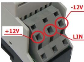
Схема подключения расходомера к адаптеру и схемы соединительных кабелей приведены на рисунке.
