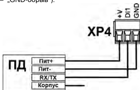
Рис. 2.3. Подключение преобразователей давления с цифровым выходным сигналом
