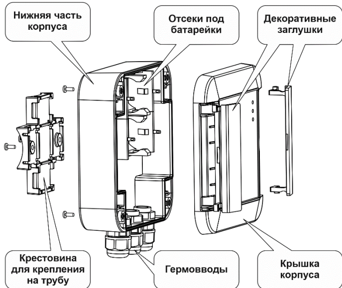
Рис.1. Конструкция терминала
