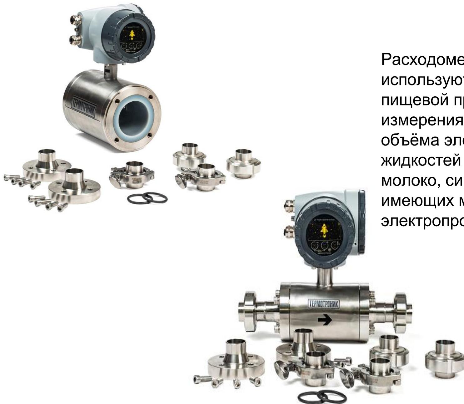
Расходомеры «ПИТЕРФЛОУ Т» используются на предприятиях пищевой промышленности для измерения объёмного расхода и объёма электропроводящих жидкостей и суспензий: вода, молоко, сиропы, пиво и т.д., имеющих минимальную электропроводность  $5 \times 10^{-4}$  См/м
