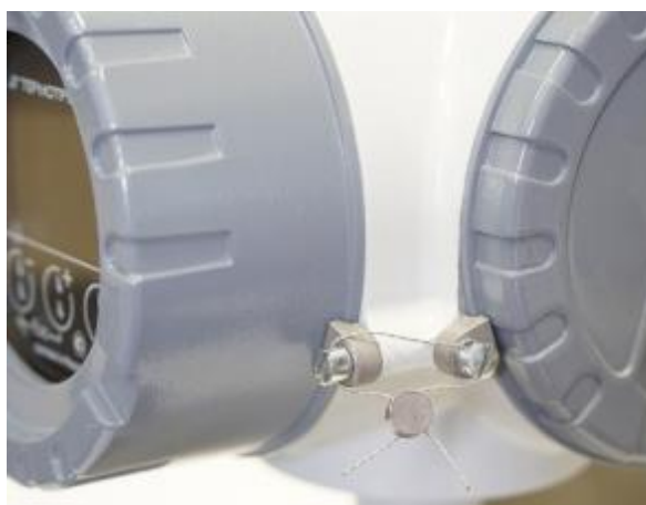
Рисунок 5 – Место пломбировки от несанкционированного доступа эксплуатирующей организацией расходомера-счётчика Питерфлоу Т модификации 3
