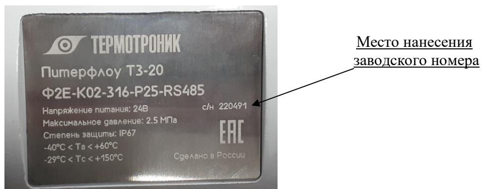
Рисунок 8 – Место нанесения знака утверждения типа на расходомер-счётчик Питерфлоу Т модификации 3
