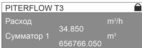
Рисунок 2.12 Главный экран в режиме индикации двух параметров
