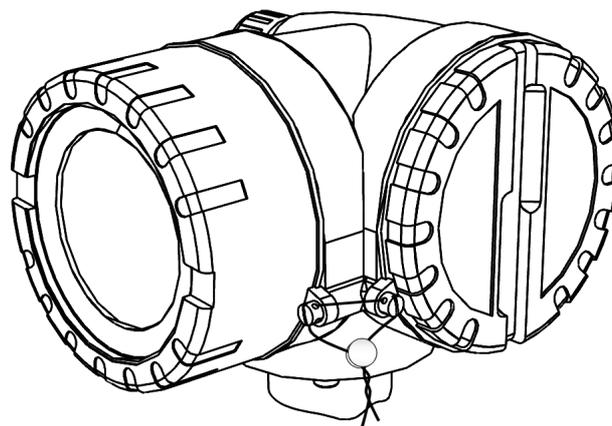
Рисунок 2.21 Пломбирование доступа к изменению метрологически значимых параметров
