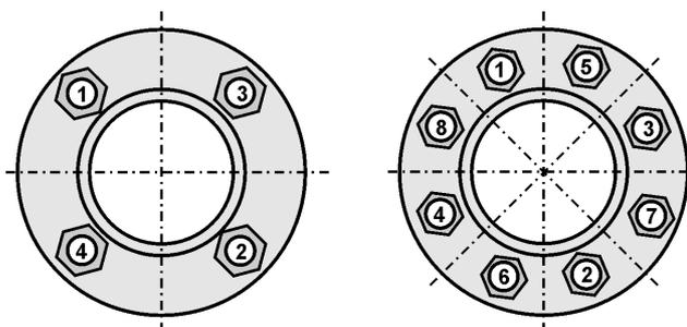
Рисунок 3.14 Порядок затяжки гаек
