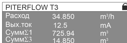
Рисунок 2.13 Главный экран в режиме индикации четырех параметров
