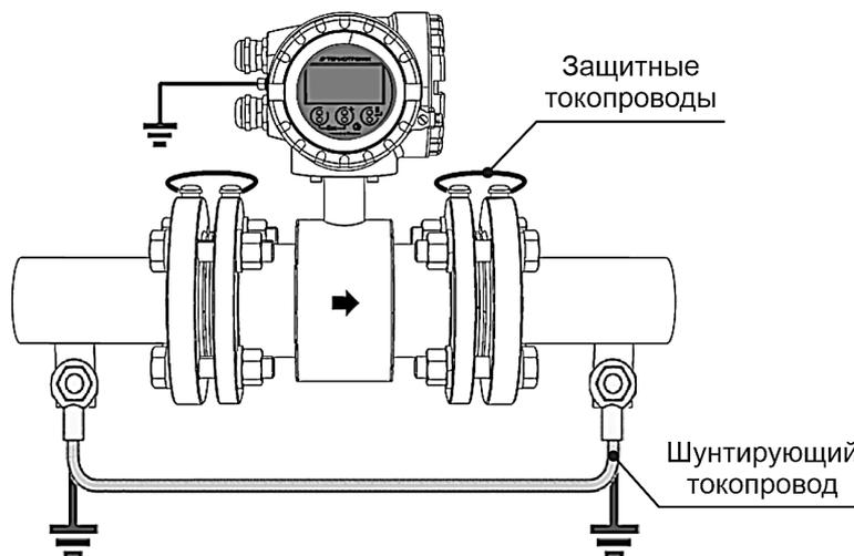
Рисунок 3.15 Выравнивание потенциалов в металлических трубах
