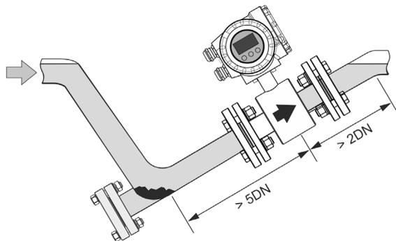
Рисунок 3.9 Установка расходомера в частично заполненном трубопроводе
