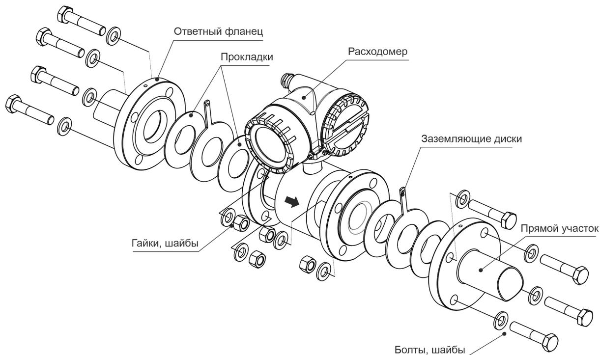
Рисунок 3.13 Установка расходомера
