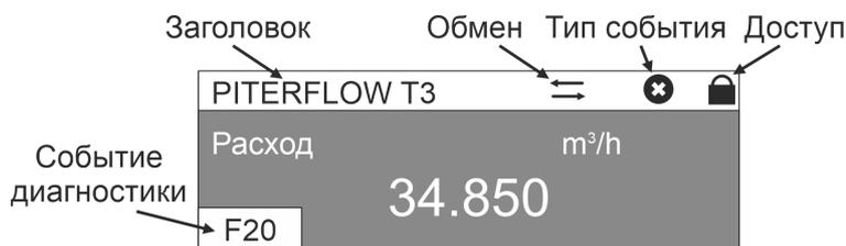
Рисунок 2.9. Общая структура экранов дисплея
