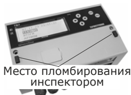
Рис. 1.2– Места пломбирования вычислителя
