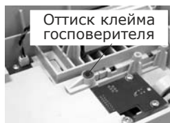
Рис. 1.2– Места пломбирования вычислителя
