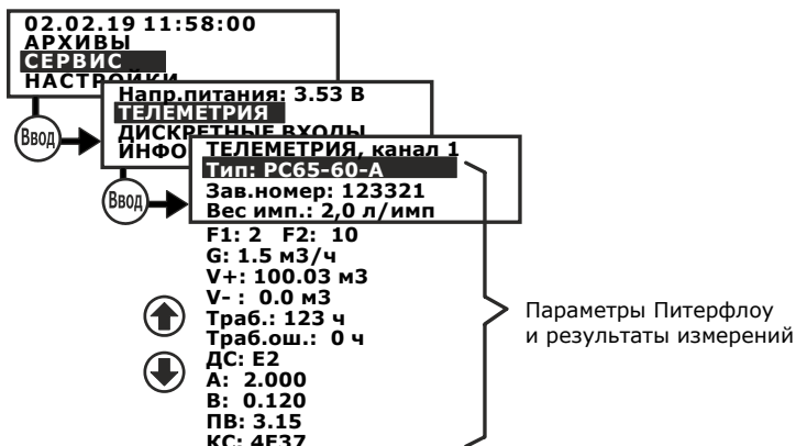
Рис. 3.11 – Порядок просмотра состояния расходомера
