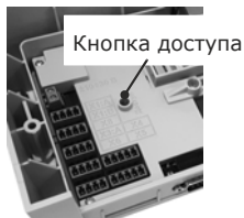
Рис. 3.2 – Расположение кнопки доступа
