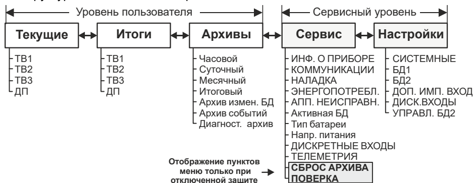
Рис. 2.6 – Структура меню тепловычислителя
