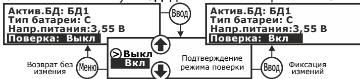
Рис. 3.16 – Включение режима проверки
